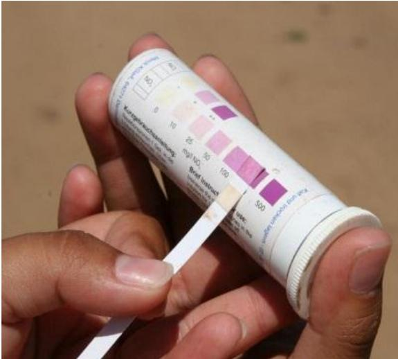
Las pruebas instantáneas de nitrato proporcionan una manera fácil y rápida de determinar la cantidad de nitrato en el suelo o agua.
