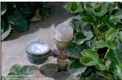
Los tensiómetros proporcionan una manera rápida y económica para determinar cuándo regar. Riegue cuando la tensión llegue hasta cierto nivel crítico establecido, por ejemplo, 15-20 cb para un suelo franco-arenoso.
